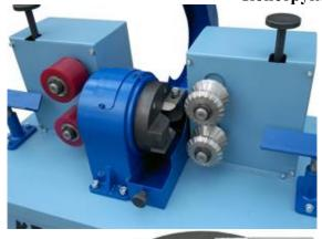
Фрезерная головка оснащается европейскими или японскими подшипниками. Ножевая насадка, измеренная и обработанная на станке ЧПУ за одну установку, обеспечивает точность, производительность и высокое качество выпускаемой продукции.
