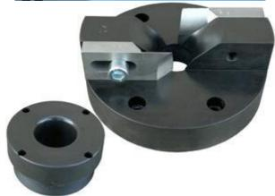
В базовой комплектации станка предлагаются ножевые барабаны и калибрующие втулки с диаметрами 32 и 40 мм. Но по заказу клиента данные комплектующие могут быть изготовлены и других необходимых размеров от 10 до 60 мм.
