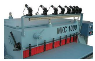
Лазерные указатели пропила. Используются для построения линии визирования при распиловке на кромкообрезных станках.
