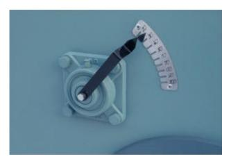
Шкала регулировки высоты пропила. На шкале отображается минимальная высота заготовки, при этом, возможна обработка разнотолщинного материала, например - тес и плаха.
