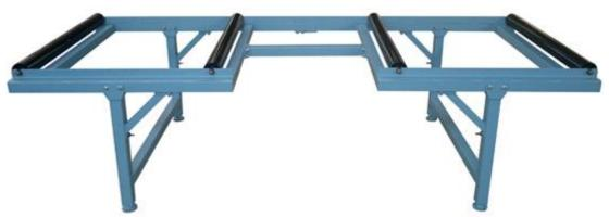
Подающий рольганг выполнен с центральным проемом для удобного позиционирования материала при подаче в станок.
