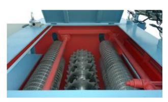
Подача и прижим заготовки осуществляется массивными приводными рябухами по всей плоскости обработки, что обеспечивает прямолинейность распиловки и высокую точность обработки.
