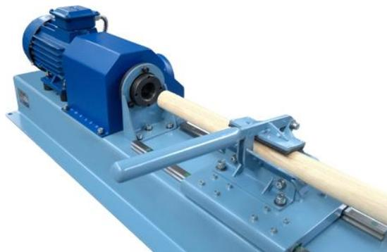
При подаче оператору нет необходимости удерживать заготовку руками. Одновременно зажим и подача заготовки осуществляются за ручку прижимного механизма.
