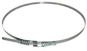
Для крепления мешков используются специально изготовленные хомуты, из конструкционной рессорно-пружинной стали (0,5х16 мм), с регулируемыми пружинными застежками. Обеспечивают быструю и надежную фиксацию.
